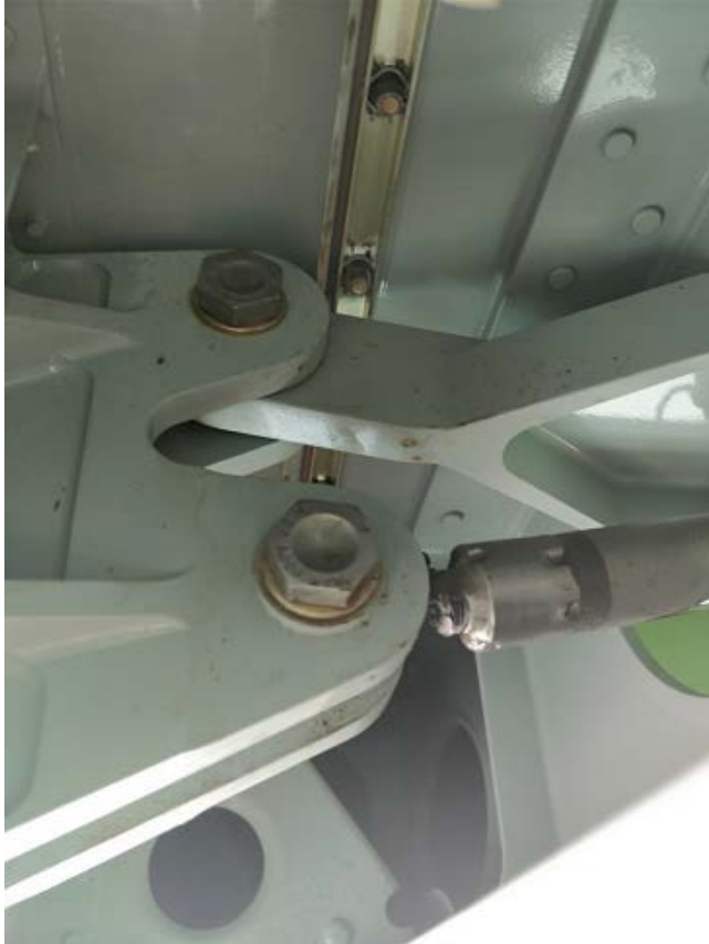
Vue latérale de la ferrure de servocommande de profondeur
