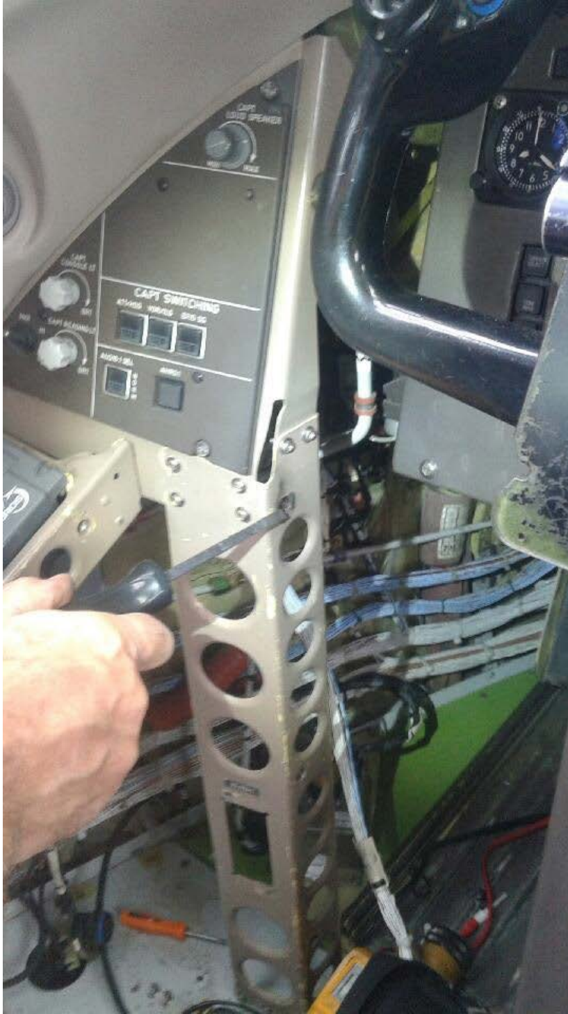
Emplacement de la fixation et indication d'arc électrique
