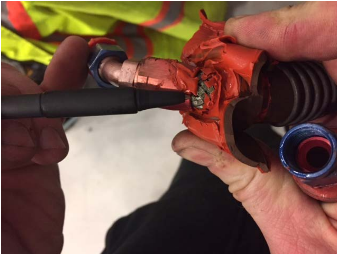
Fuite dans une conduite de carburant tressée
