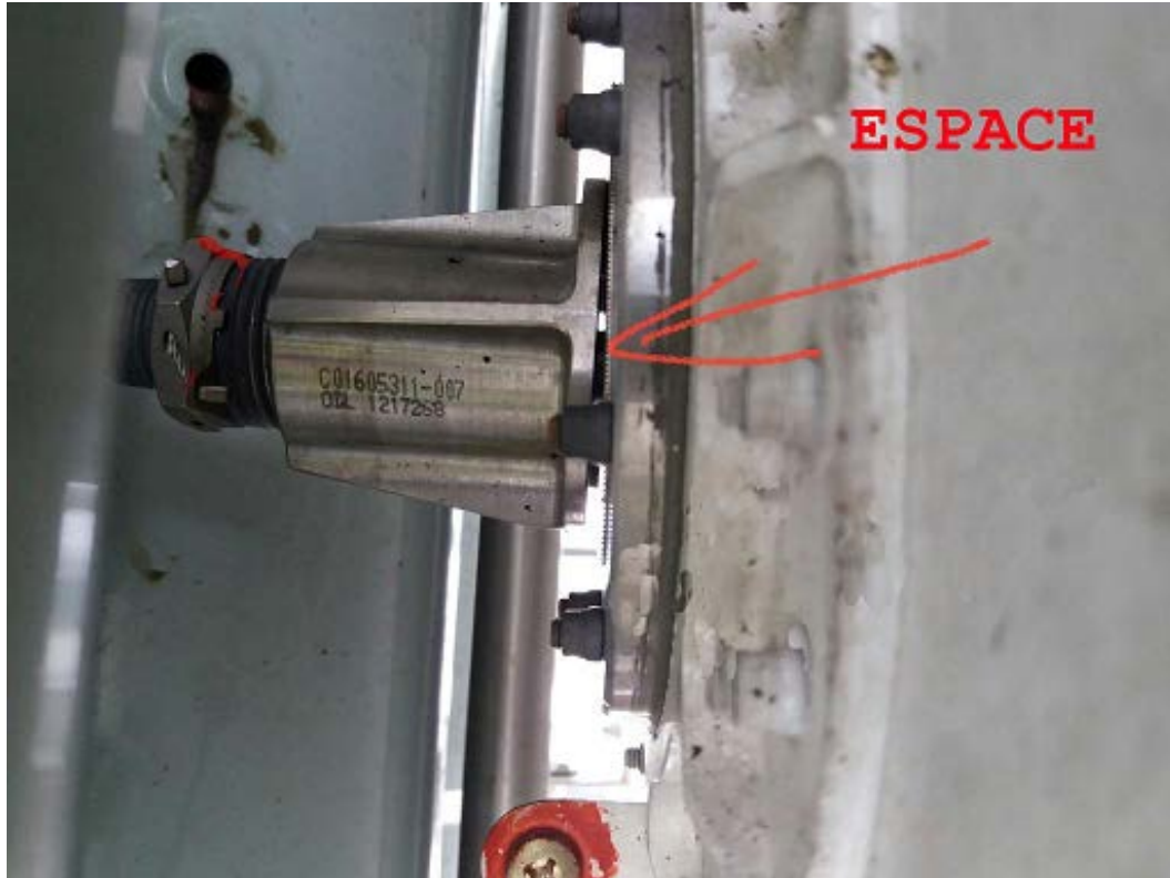
Raccord desserré de la porte du train d'atterrissage principal – espace
