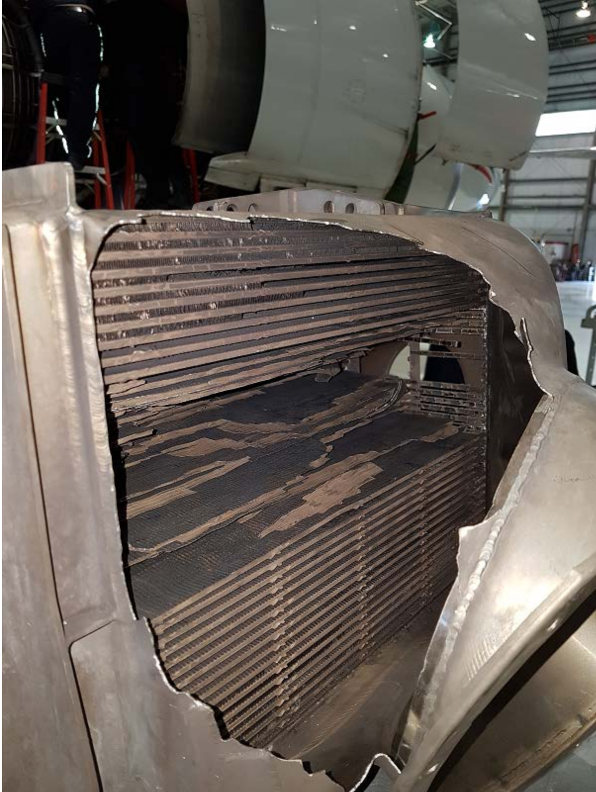
Gros plan du trou dans le logement et des ailettes manquantes dans la structure interne.
