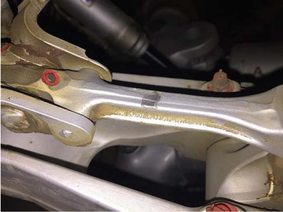
Domage causé à la bielle par le contact avec le collier
