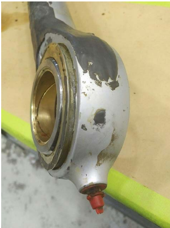
Roulement sortant de son logement
