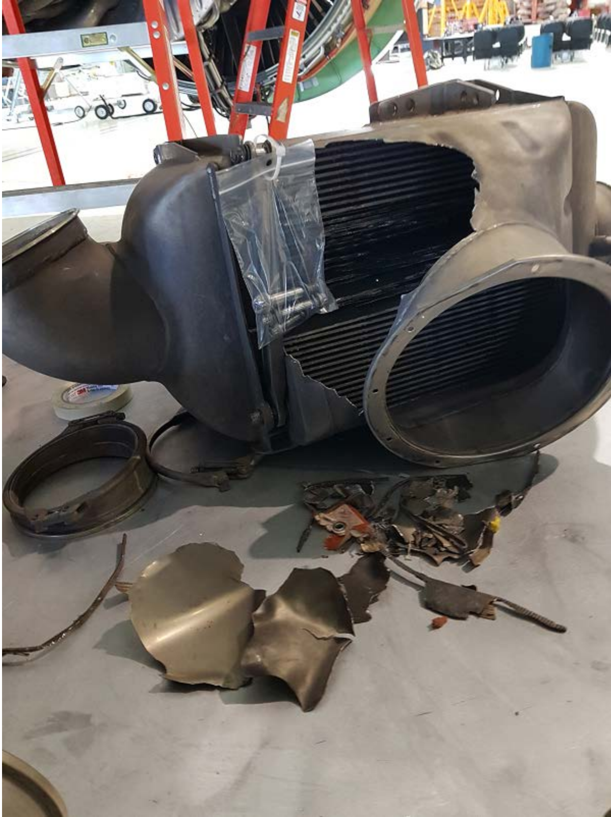
Pré-refroidisseur avec pièces du logement
